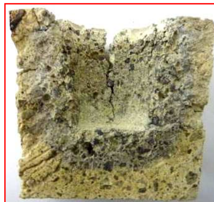
Žárobeton s nízkým obsahem cementu na bázi mullitu – destrukce materiálu vlivem koroze alkáliemi
