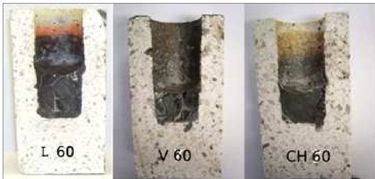
Obr. č. 2 Výsledky testu koroze struskou u vzorků L 60, V60, CH60.
